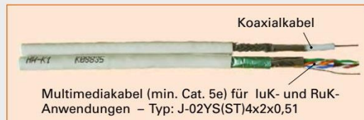
Bild 3: Multimediakabel (Hybridkabel)
